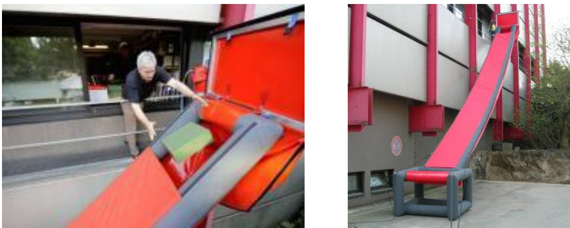
Bücherbergungsrutsche in Hannover (das rechte Foto stammt aus dem Beitrag in b-i-t-online).
